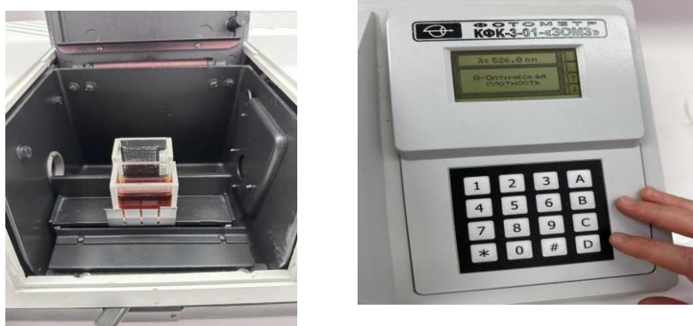
Рис. 20-21 Измерение оптической плотности
